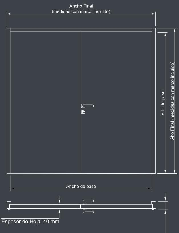
Ancho Exterior Máximo 2200 mm/Alto Exterior Máximo 3000 mm
