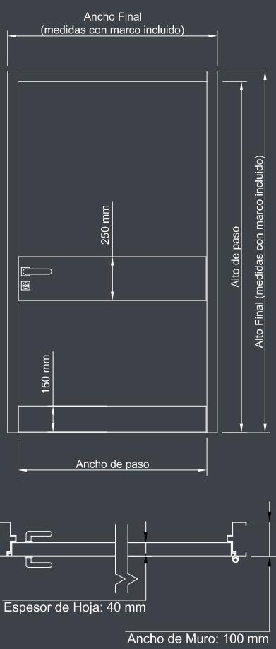
Ancho Exterior Máximo 1500 mm/Alto Exterior Máximo 3000 mm
